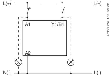
Управляющий вход **Y1/B1** переключается при появлении на нем электрического потенциала относительно **A2**. Возможно использовать напряжение питания с клеммы **A1** или другое напряжение в пределах диапазона номинального напряжения питания.
