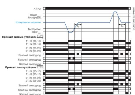
Контроль диапазона напряжения с задержкой на отпускание и с параллельным переключением выходных контактов
