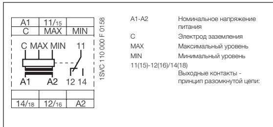
Схема подключения CM-ENN
