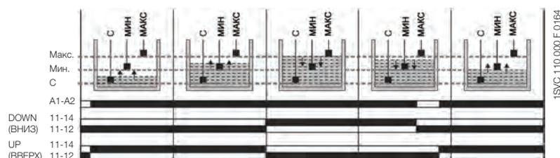
Устройство CM-ENS UP/DOWN контролирует уровни проводящих жидкостей и других сред, и применяется, например, для контроля уровня жидкости в насосных системах.
