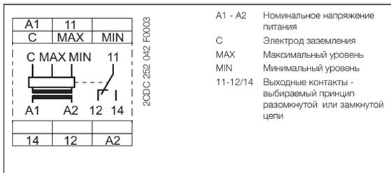
Схема подключения CM-ENN UP/DOWN
