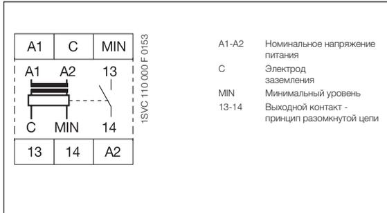
Схема подключения CM-ENE MAX
