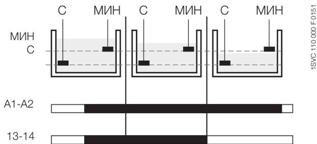
Реле контроля уровня жидкости CM-ENE MIN и CM-ENE MAX используются для контроля уровня проводящих жидкостей, например, в системах управления насосами для контроля сухого хода или переполнения.
