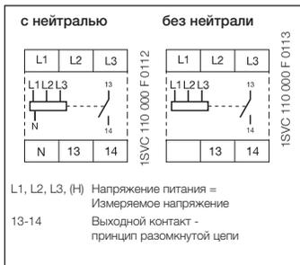
Схема подключения CM-PSS.x1
