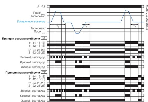
Контроль диапазона тока с задержкой на отпускание (ВыКЛ) и с параллельным переключением выходных контактов (1x2 c/o)
