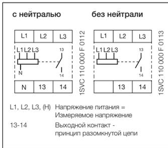
Схема подключения CM-PVS.x1
