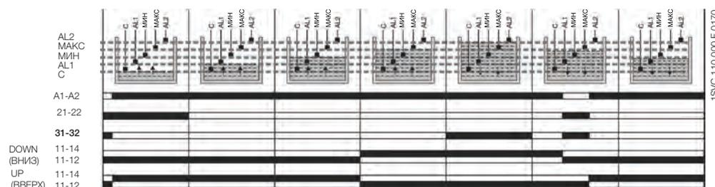
Если используется металлический бак, электрод заземления C не требуется. В этом случае кабель может быть подключен непосредственно к металлической поверхности резервуара.
