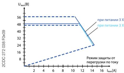
CP-T 48/10.0 режим защиты от перегрузки по току
