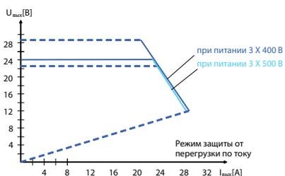
CP-T 24/20.0 режим защиты от перегрузки по току
