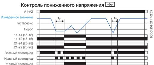
В зависимости от конфигурации, реле контроля напряжения CM-ESS.1 и CM-ESS.2 могут использоваться для контроля максимального (1x1 c/o) или минимального (1x1 c/o) напряжения в однофазных системах переменного или/и постоянного тока. Контролируемое напряжение (измеряемое значение) прикладывается к клеммам В-С. Реле функционирует по принципу разомкнутой цепи.
