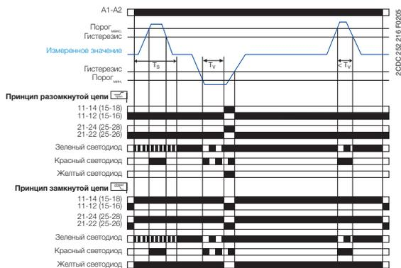
Контроль диапазона тока с задержкой срабатывания (ВКЛ) и с параллельным переключением выходных контактов (1x2 c/o)
