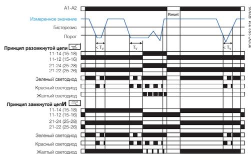
Если контролируемое напряжение превысит или соответственно упадет ниже заданного порога срабатывания, начнется отсчет задержки срабатывания  $T_v$ . Если отсчет времени  $T_v$  закончился, а напряжение все еще превышает/остается ниже порогового значения, за минусом/плюсом заданного гистерезиса, выходные реле возбуждаются (↗) /обесточиваются (↘).
