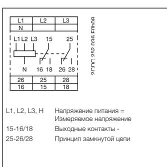
Схема подключения CM-MPN.x2
