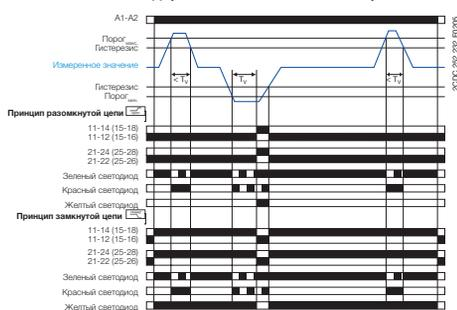
Контроль диапазона напряжения с задержкой срабатывания и с параллельным переключением выходных контактов
