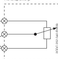
Примечание: клеммы потенциометра не промаркированы
