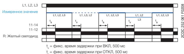
При наличии всех трех фаз и корректном чередовании фаз выходное реле активируется (контакт замкнут) после истечения времени выдержки при включении  $t_s$ . Если произошел обрыв фазы или нарушается последовательность чередования фаз, начинается отсчет времени выдержки при отключении  $t_v$ . По истечении времени выдержки выходное реле обесточивается (контакт разомкнут). Когда реле активировано светится желтый светодиод (СИД).
