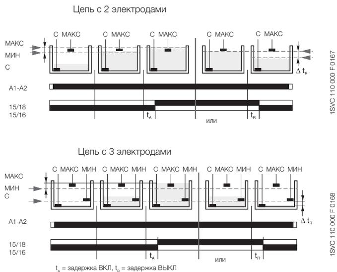
Устройство CM-ENN контролирует уровни проводящих жидкостей и применяется, например, для контроля уровня жидкости в насосных системах для защиты от сухого хода погружных насосов или контроля переполнения резервуаров. Оно также подходит для контроля проводимости жидкостей. Принцип измерения основан на изменении сопротивления, которое замеряется с помощью однополюсных электродов (смоченных или нет).
