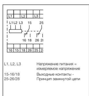
Схема подключения CM-PAS.x1
