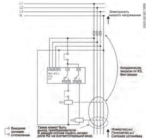
Автоматическое подключение к электросети вместо постоянно доступной точки коммутации с функцией отключения.
