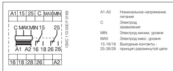
Схема подключения CM-ENS UP/DOWN
