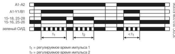
t<sub>1</sub> = регулируемое время импульса 1
